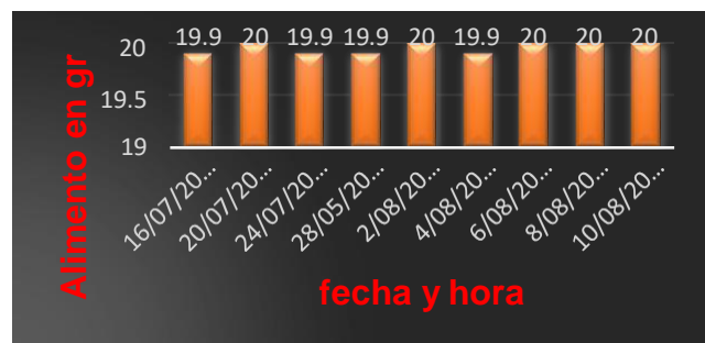
Figura 13. Comprobación de dosificación de alimento
