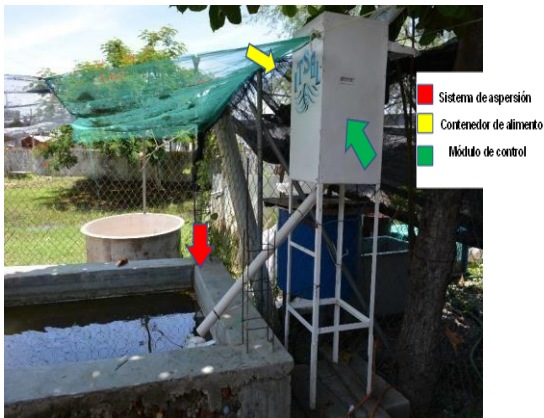
Figura 11. Alimentador automatizado etapa 2
