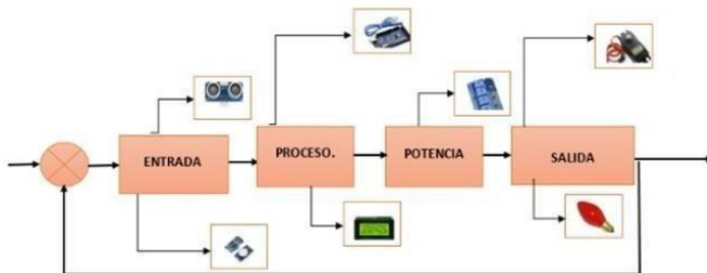
Figura 7. Módulos del alimentador etapa 2.
